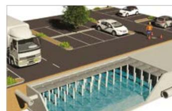
**Sistemi per la creazione di serbatoi interrati e carrabili**
