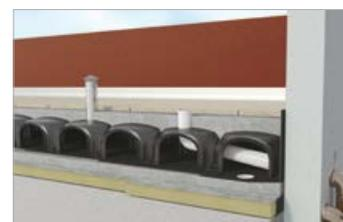
**Sistemi per la creazione di tetti ventilati inclinati o piani**
