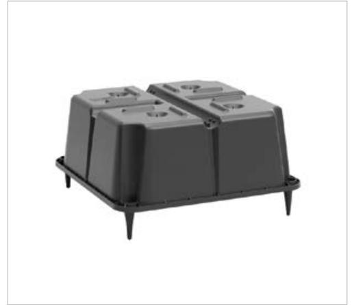
U-Boot® Beton est un coffrage en polypropylène recyclé, conçu pour créer des dalles et des radiers allégés en béton armé. L'emploi des coffrages U-Boot® Beton permet de réaliser des planchers dalles, avec la possibilité d'avoir le chapiteau dans l'épaisseur du plancher.
