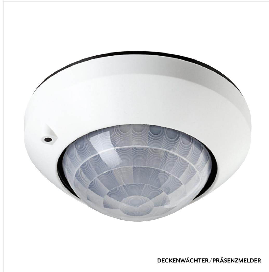
Der Deckenwächter / Präsenzmelder arbeitet äußerst präzise. In einer Montagehöhe von bis zu sechs Metern erfasst er alles, was sich im Umkreis von rund 20 Metern bewegt. Dazu besitzt das Gerät drei voneinander unabhängige PIR-Sensoren. Alle Einstellungen werden komfortabel über die Clever Config App vorgenommen.
