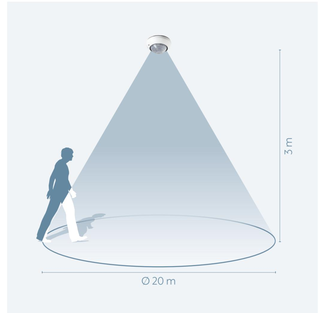
In Gängen und Fluren zeigt der Deckenwächter seine Stärken. Das Gerät verfügt über einen 360°-Erfassungsbereich mit einem Radius von 20 Metern – ausgehend von einer Installation in drei Metern Höhe. Mit einem Erfassungswinkel von je 120° erfasst jeder der drei PIR-Sensoren einen eigenen Bereich – jeder ist einzeln aktivierbar. Durch eine Gruppierung von bis zu fünf Geräten erweitert sich der Erfassungsbereich. In seiner Eigenschaft als Präsenzmelder sorgt
