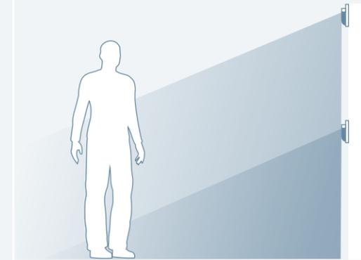
Der horizontale Erfassungsbereich von 180° wird von zwei PIR-Sensoren überwacht, die einzeln oder zusammen genutzt werden können. In der Funktion als Bewegungsmelder eignen sie sich ideal in Fluren und Durchgängen.
