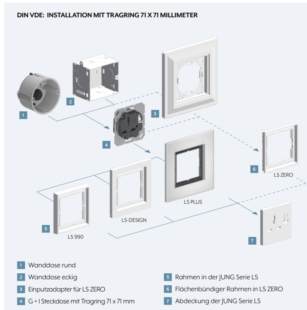
Wird die G + I Steckdose in eine Gerätedose nach DIN VDE installiert, sind Kombinationen in bis zu fünffachen Rahmen möglich. So ergeben sich zahlreiche Funktionsmöglichkeiten.
