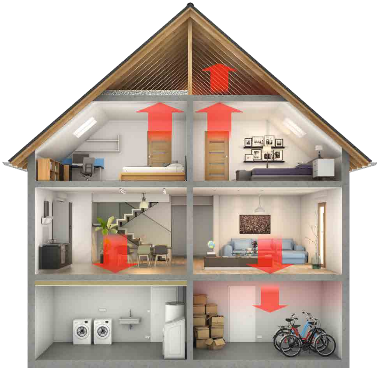
Gedämmte Kellerdecke und gedämmter Dachboden Erhalt von Wärme im Wohnraum
