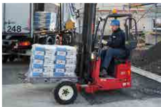
Mitnahmestapler: Eigengewicht: ca. 2 t Breite: ca. 2,3 m Masthöhe: ca. 2,4 m
