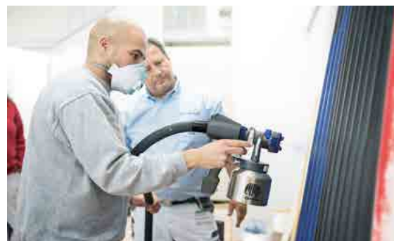
Effizient arbeiten: die nebelarme Spritztechnologie NAST in der Anwendung
