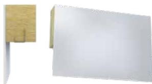
L-Form aus MW mit WLZ 040, Vlieskaschierung auf Innenseite und Unterseite, Frontseite mit Putzträgerplatte, integriertes Alu-U-Profil.
