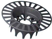
Spezieller Dübelzylinder für die vertiefte Montage des Capatect Universaldübels 053 in MW-Dämmplatten 035 WAP-zg/zh und PF-Dämmplatten 122. Zylinder Ø 112 mm.
