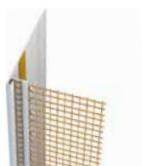
Winkelprofil mit Kunststoffschenkel zur Ausbildung von thermisch entkoppelten Anschlüssen an andere Bauteile, insbesondere für die vertikale Anschlusssituation. Abzugskante: gerade, Schenkellänge: 80 mm.
