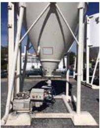
Zum Trockenfördern für mineralische Produkte aus Drucksilos
