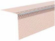
Abschlussprofil für den Übergang von vertikalen zu horizontalen Flächen unter einer Fensterbank bei der Erstellung einer 2. Dichtebene. Winkelprofil mit Abzugskante und beidseitigen Gewebestreifen.
