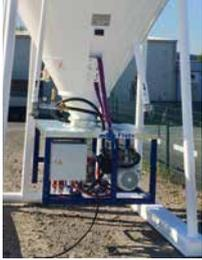
Zum Trockenfördern für mineralische Produkte aus Drucksilos mit höherer Kompressorleistung für schnelleres Fördern
