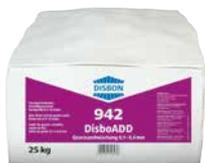
Feuergetrockneter Kristallquarzsand. Korngröße 0,1–0,4 mm. Zum Absanden frischer Grundierungen und Beschichtungen sowie zur Herstellung von Antirutsch-Beschichtungen und Verlaufmörteln.
