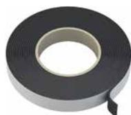
Einseitig selbstklebendes, komprimiertes Fugendichtband zur schlagregensicheren Abdichtung von Anschlüssen an angrenzende Bauteile. Speziell für den Einbau hinter dem Anschraubsteg der Fensterbank im Anschluss zum Blendrahmen geeignet.
