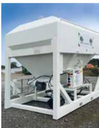
Kettensilo mit integriertem Durchlaufmischer, Förderpumpe und Kompressor zum Mischen und Pumpen von mineralischen Produkten
