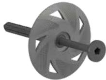
Schraubdübel mit vormontierter, glasfaserverstärkter Kunststoffschraube und Dübelteller für Dämmstoffdicken von 20–60 mm in oberflächenbündiger Montage.
