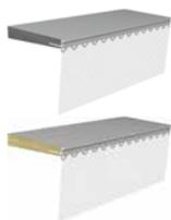
Vorgefertigte Fensterbank-Keilplatte aus XPS mit WLZ 031 mit 5 Grad Neigung und glatter wasserdichter Oberfläche mit Abtropfkante und fassadenseitiger Gewebefahne zur Ausbildung einer Dichtebene unterhalb der Fensterbank.
