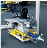
Offenes System zum Pumpen von mineralischen Produkten unter einem Durchlaufmischer
