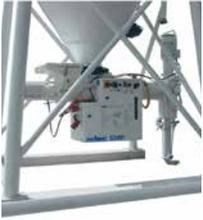
Geschlossenes 2-Kammer-System zum Mischen und Pumpen von mineralischen Produkten aus Freifallsilos
