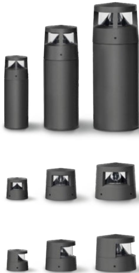
Reef è una famiglia di short bollard con emissione di luce radiale ottenuta tramite un specifico riflettore conico. Adatti ad illuminare in radenza percorsi pedonali di aree residenziali, parchi e zone pubbliche, sono proposti in tre diverse dimensioni, tutte caratterizzate da un design pulito. Il diffusore in policarbonato gli conferisce un'elevata resistenza agli atti vandalici.
