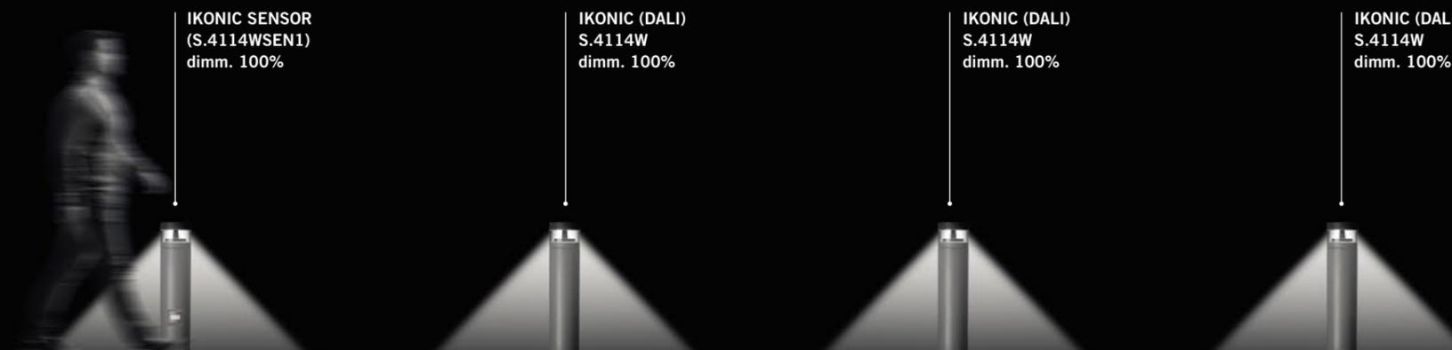
Après le délai prédéfini (ou en cas de détection d'un éventuel deuxième capteur placé à l'extrémité du chemin), les bornes lumineuses retournent au mode veille en diminuant ou en éteignant la quantité de lumière émise.
