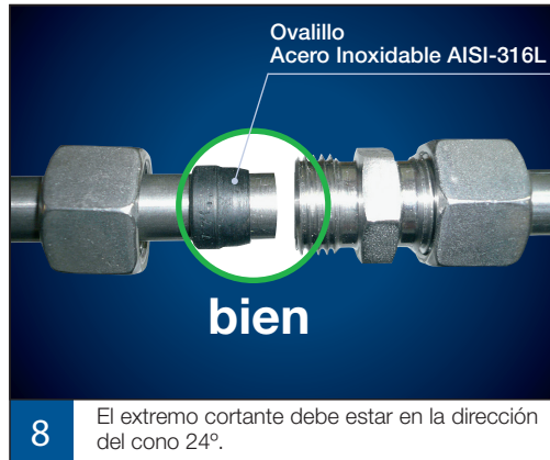
7 Deslizar la tuerca y colocar el anillo cortante en el extremo del tubo.
