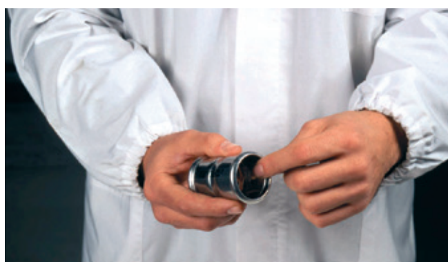
Comprobar la junta tórica
