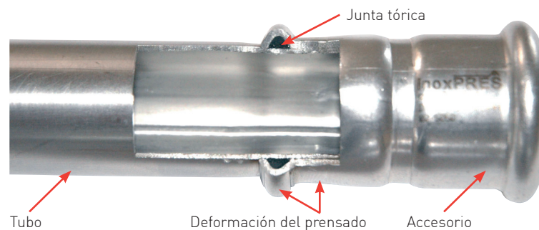
Fig. 2a - Unión prensada.
