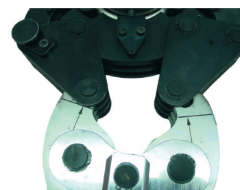
Fig. 58a - Mordaza Klauke UAP 100120 CFM mal introducida NO PENSAR.
