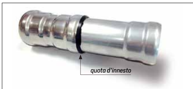
Figura 9 - Controllo completo inserimento del tubo nel bicchiere
