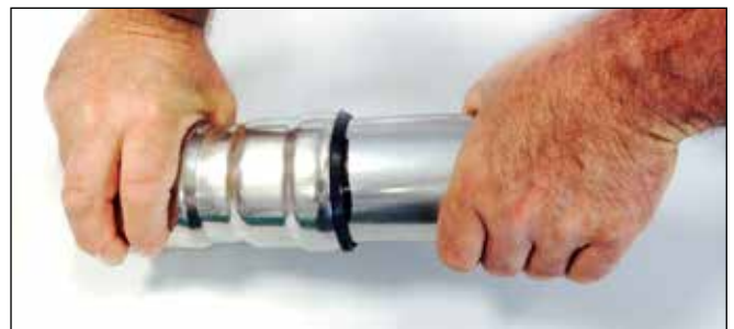
Figura 7 – Einsetzen des Rohrs in das Verbindungsstück
