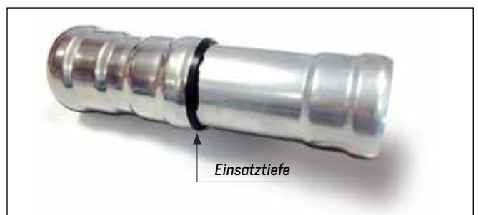
Figura 9 – Kontrollieren, ob das Rohr komplett in den Becher eingeführt ist
