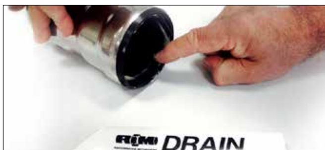
Figura 6 - Lubrificazione zona interna guarnizione
