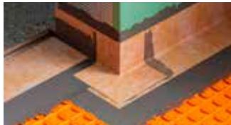
Schlüter-KERDI-CID sind Andichtungs-Sets zur Kapillarunterbrechung am Boden in Tür-Durchgangsbereichen nach DIN 18534. Es gibt je ein Set für die Türöffnungsrichtung nach innen und nach außen. Set-Bestandteile sind eine Schlüter-SCHIENE-E mit aufkaschiertem KERDI-KEBA-Dichtband sowie passende KERDI-KERECK-Formteile. (Produktdatenblatt 8.11)
