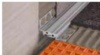
Schlüter-DILEX-BTO ist ein Bautrennfugenprofil aus Aluminium für Boden-/ Wandübergänge. Durch die seitliche Gelenkanbindung des ineinander verschiebbaren Mittelteils ist eine dreidimensionale Bewegungsaufnahme möglich.
