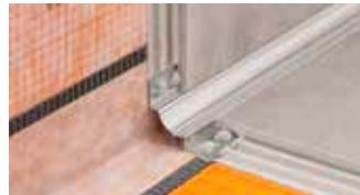
Schlüter-DILEX-HKS ist eine Kombination aus einer Edelstahl-Hohlkehle und einem flexiblen Bewegungsfugenprofil für den Boden-/Wandanschluss von Fliesenbelägen.
