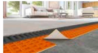
Schlüter-DITRA-PS ist eine Polypropylenbahn mit hinterschnittenen quadratischen Vertiefungen im Easyfill-Design, die rückseitig mit einem selbstklebenden Trägervlies versehen ist. Die Matte ist wasserundurchlässig. Nach Abziehen der Schutzfolie kann DITRA-PS auf geeigneten Untergründen ohne Verwendung von Fliesenkleber verlegt werden und dient somit als Entkopplungs- und Dampfdruckausgleichsschicht. (Produktdatenblatt 6.7)
