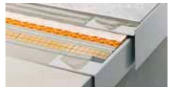
Schlüter-BARA-RT / -RTC sind T-förmige Randprofile aus farbig beschichtetem Aluminium zur Begrenzung der freien Randbereiche an Balkonen und Terrassen. Der obere Abschlusschenkel deckt die Belagskante ab, der untere bildet eine Tropfkante und verdeckt eventuell die Fuge zur TROBA-Flächendrainage.
