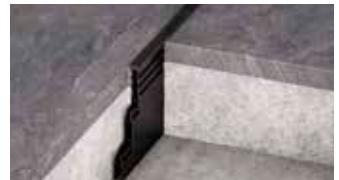
Schlüter-DILEX-MP ist ein Dehnungsfugenprofil mit hinterschnittenen Seitenwänden aus Hart-PVC-Regenerat und einer die Seitenwände überdeckenden Dehnzone aus Weich-Kunststoff mit Verlängerungsprofilen für den Einbau bei Mörtelverlegung.
