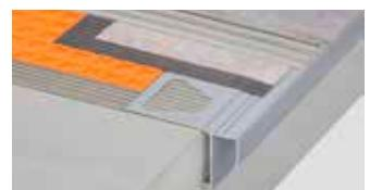
Schlüter-BARA-RAK ist ein Balkon-Randprofil mit Tropfkante aus farbig beschichtetem Aluminium. Es wird im Randbereich auf einer fertigen Gefällefläche verlegt und dient dort als Randabschluss und Tropfkante.
