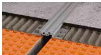
Schlüter-DILEX-BT ist ein Bautrennfugenprofil aus Aluminium mit seitlicher Gelenkanbindung des ineinander verschiebbaren Mittelteils. Somit ist eine dreidimensionale Bewegungsaufnahme möglich.
