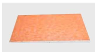
Schlüter-KERDI-SHOWER-LT / -LTS sind Gefälleboards aus druckstabilem Polystyrol mit einer werkseitig aufkaschierten Schlüter-KERDI Abdichtung. In bodengleichen Duschen stellen sie ein ausreichendes Gefälle zur Linienentwässerung Schlüter-KERDI-LINE her. Individuelle Abmessungen lassen sich anhand vorgegebener Schneidnuten individuell mit dem Cuttermesser zuschneiden. (Produktdatenblatt 8.8)
