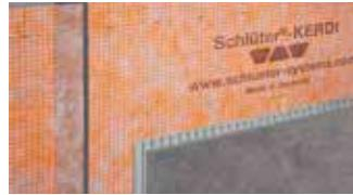
Schlüter-KERDI ist eine Abdichtungsbahn aus Polyethylen, welche zur Verankerung in dem Fliesenkleber beidseitig mit Vliesmaterial versehen ist. Sie eignet sich besonders für Abdichtungen im Verbund mit Fliesenbelägen an Wand und Boden. Schlüter-KERDI-DS ist aufgrund des hohen Wasserdiffusionswiderstands für den Einsatz als Dampfsperre im Verbund mit Fliesenbelag geeignet. (Produktdatenblatt 8.1)
