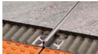
Schlüter-DILEX-EDP ist ein Bewegungsprofil aus Edelstahl, welches durch eine Nut- und Federverbindung horizontale Bewegungen aufnehmen kann.
