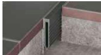
Schlüter-DILEX-MOP ist ein Dehnungsfugenprofil mit stabilen gezahnten Seitenwänden aus Hart-PVC-Regenerat und einer zwischen den Seitenwänden liegenden Dehnzone aus grauem Weich-Kunststoff für den Einbau bei Mörtelverlegung.
