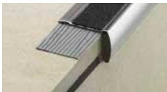
Schlüter-TREP-GK ist ein Treppenprofil aus gebürstetem Edelstahl mit einer eingeklebten rutschhemmenden Auftrittsfläche. Es lässt sich nachträglich auf Stufen aus Fliesen oder Natursteinplatten aufkleben.
