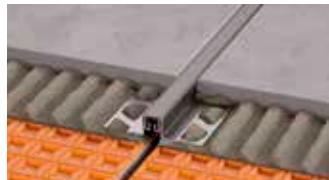
Schlüter-DILEX-KS ist ein Bewegungsprofil mit Kantenschutz, bestehend aus seitlichen Befestigungsschenkeln aus Aluminium oder Edelstahl, die mit einer auswechselbaren Dehnzone aus weichem Kunststoff verbunden sind.
