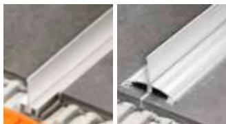
Schlüter-SHOWERPROFILE-WS /-WSK sind zweiteilige Profile aus eloxiertem Aluminium für den Schwallschutz in bodenebenen Duschanlagen. Das Trägerprofil zu SHOWERPROFILE-WSK wird nachträglich auf vorhandene Beläge aufgeklebt. Das Trägerprofil zu SHOWERPROFILE-WS wird im Zuge der Fliesenverlegung im Kleberbett verankert. Beide Varianten sind für das Befahren mit Rollstühlen geeignet. (Produktdatenblatt 14.2)
