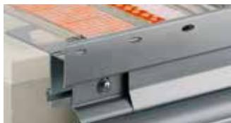
Schlüter-BARA-RTKE ist ein Randprofil mit Tropfkante zur Verlegung auf einen fertigen Gefällestrich. Das Profil hat eine Aufnahmeverrichtung zur Befestigung des Rinnensystems Schlüter-BARIN. Das Profil BARA-RTKE ist besonders gut für den Konstruktionsaufbau mit der Verbunddrainage Schlüter-DITRA-DRAIN geeignet. Durch die gelochte Aufkantung erhält man einen sauberen Fliesenabschluss.
