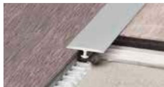
Schlüter-VINPRO-T Profil, welches nachträglich als Übergang höhengleich aneinander angrenzender, elastischer Bodenbeläge eingesetzt wird. Das Profil überdeckt die angrenzenden Belagsmaterialien und dient somit als Kantenschutz.
