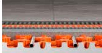
Schlüter-BEKOTEC-EN / EN 23 FI 30 ist die sichere Belagkonstruktionstechnik für die Herstellung rissefreier und funktionssicherer Estriche und Heizestrichen in niedrigen Schichtdicken ab 52 mm (inkl. 20 mm Dämmung). BEKOTEC-EN 23 FI 30 ist mit einer 30 mm dicken Trittschalldämmung versehen. Neben Fliesen und Naturstein können auch andere Belagsmaterialien auf dem BEKOTEC-Estrich verlegt werden.
