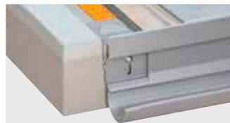
Schlüter-BARA-RTKEG ist ein Randprofil mit Tropfkante zur Verlegung auf einen fertigen Gefällestrich. Das Profil hat eine Aufnahmeverrichtung zur Befestigung des Rinnensystems Schlüter-BARIN. Es ist für den Konstruktionsaufbau mit der Verbundentkopplung Schlüter-DITRA ausgelegt. Durch die geschlossene Aufkantung erhält man einen sauberen Fliesenabschluss.
