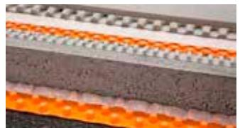
Schlüter-TROBA-PLUS ist eine dauerhaft wirksame kapillarbrechende Flächendrainage, die anfallendes Wasser sicher abführt. Die engstehenden als Kegelstumpf ausgebildeten Noppen sind hochbelastbar und mit einem aufkaschierten wasserdurchlässigen Vlies überdeckt. Diese stelzen den Belag ganzflächig auf und bilden so einen durchgängigen Drainageraum. (Produktdatenblatt 7.2)
