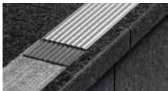
Schlüter-TREP-EFK ist ein Profil aus Edelstahl mit spezieller rutschhemmender Profilierung zur sicheren und optisch ansprechenden Ausgestaltung von Stufenkanten. Es kann mit Montagekleber in dafür vorgesehene Ausfrässungen oder nachträglich auf Trittstufen angebracht werden.
