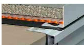
Schlüter-BARA-RWL ist ein Randprofil mit Entwässerungslöchern aus beschichtetem Aluminium für den Randbereich von Balkonen und Terrassen. Es eignet sich besonders für den Abschluss von Balkon- und Terrassenbelägen, die lose auf Kies oder Stelzlager verlegt werden.
