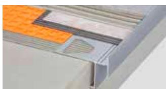
Schlüter-BARA-RAKEG ist ein Randprofil mit Tropfkante zur Verlegung auf einen fertigen Gefällestrich. Es ist für den Konstruktionsaufbau mit der Verbundentkopplung Schlüter-DITRA 25 ausgelegt. Durch die geschlossene Aufkantung erhält man einen sauberen Fliesenabschluss.
