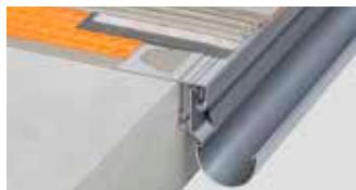
Schlüter-BARA-RTK ist ein Randprofil mit Tropfkante zur Verlegung auf einen fertigen Gefällestrich. Das Profil hat eine Aufnahmeverrichtung zur Befestigung des Rinnensystems Schlüter-BARIN. Die Fliesen können mit Überstand verlegt werden. Alternativ kann auf dem vertieften Übergang zur Tropfkante ein Schlüter-JOLLY als Abschluss der Fliesenkante aufgebracht werden.
