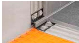
Schlüter-DILEX-RF ist ein zweiteiliges Profil aus Hart- / Weich-Kunststoff mit einer Nut- und Federverbindung für dauerhaft flexible und wartungsfreie Randfugen als Boden- / Wand- bzw. Sockelanschluss.
