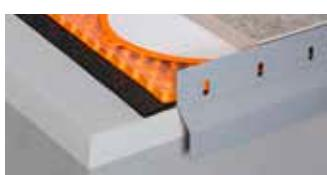
Schlüter-BARA-RKL ist ein winkelförmiges Randprofil mit Entwässerungslöchern aus farbig beschichtetem Aluminium. Es eignet sich für großformatige Plattenelemente, die wahlweise auf ungebundene Kies-/Splitschüttungen oder auf Stelzlager verlegt werden.
