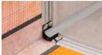
Schlüter-DILEX-HK ist ein Hohlkehlpfrol aus hartem PVC-Regenerat mit einer Hohlkehle aus Weich-Kunststoff und integrierter Fliesenkammer für den Wand-/Bodenanschluss. Das Profil erfüllt besondere Anforderungen an Hygiene und Reinigungsmöglichkeiten, wie sie zum Beispiel in der Lebensmittelindustrie oder in Großküchen bestehen.
