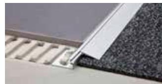
Schlüter-RENO-V ist ein Profil mit variablen Übergangsschenkel zur stufenlosen Verbindung verschiedener hoher Bodenbeläge. Durch den Fugensteg wird eine definierte Fugenkammer zur Fliese vorgegeben.
