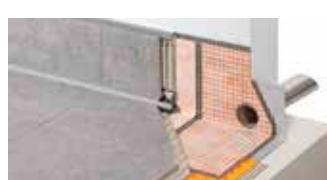
Schlüter-KERDI-DRAIN-SP-E ist ein Edelstahl-Speier zur Entwässerung von Balkon- und Terrassenflächen, die durch eine Brüstung begrenzt werden. Auf dem Klebeflansch wird die mitgelieferte Schlüter-KERDI-Manschette als Dichtanschluss verklebt und dadurch eine einfache und sichere Anbindung von Verbundabdichtungen gewährleistet. (Produktdatenblatt 8.5)
