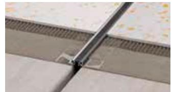
Schlüter-DILEX-EKSB ist ein Bewegungsprofil mit Kantenschutz für Beschichtungen und sonstige dünnsschichtige Bodenbeläge. Es besteht aus seitlichen Befestigungsschenkeln aus Edelstahl, die mit einer nichtauswechselbaren Dehnzone aus weichem Kunststoff verbunden sind.
