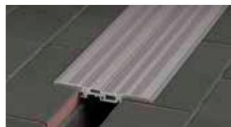
Schlüter-DILEX-BTS ist ein Bautrennfugenprofil aus Aluminium für den nachträglichen Einbau in fertige Belagsflächen. Durch die seitliche Gelenkanbindung des ineinander verschiebbaren Mittelteils ist eine dreidimensionale Bewegungsaufnahme möglich.
