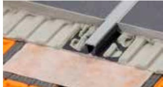
Schlüter-DILEX-BWB ist ein Bewegungsfugenprofil mit Seitenteilen aus Hart-PVC-Regenerat. Die obere Bewegungszone besteht aus weichem Kunststoff und bildet die 10 mm breite Sichtfläche.
