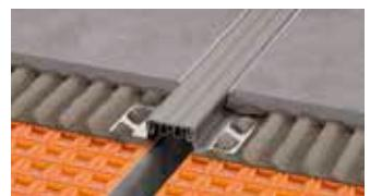
Schlüter-DILEX-KSBT ist ein Bautrennfugenprofil mit Kantenschutz, bestehend aus seitlichen Befestigungsschenkeln aus Aluminium oder Edelstahl, die mit einer 20 oder 30 mm breiten Bewegungszone aus weichem Kunststoff verbunden sind.
