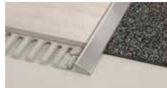
Schlüter-RENO-U ist ein Profil zum stufenlosen Übergang verschiedener hoher Bodenbeläge. Durch den Fugensteg wird eine definierte Fugenkammer zur Fliese vorgegeben. Schlüter-RENO-EU, -EBU und -MU haben keinen Fugensteg.
