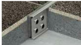
Schlüter-DILEX-EMP ist ein Bewegungsprofil aus Edelstahl für die Mörtelbettverlegung, welches durch eine Nut- / Federverbindung horizontale Bewegungen aufnehmen kann.
