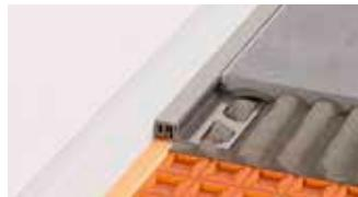
Schlüter-DILEX-KSA ist ein Anschlussprofil mit Kantenschutz, bestehend aus einem seitlichen Befestigungsschenkel aus Aluminium oder Edelstahl, der mit einer auswechselbaren Dehnzone aus weichem Kunststoff verbunden ist. Es dient zum Anschluss von Belagsflächen an feste Einbauteile wie z. B. Fensterelementen.
