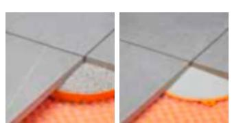
Schlüter-TROBA-STELZ-MR/-DR sind Kunststoffringe, die als Verlegehilfe für großformatige Plattenelemente auf Balkonen und Terrassen dienen. Die 25 mm hohen STELZ-MR-Kunststoffringe werden an den Fugenkreuzungspunkten der Plattenelemente mit Mörtel ausgefüllt, worauf dann die Plattenelemente verlegt werden. Schlüter-TROBA-STELZ-DR sind lediglich 2 mm hoch und werden als Schalungsringe für Dünnbettmörtel auf TROBA-PLUS 8G verlegt. (Produktdatenblätter 7.3 bzw. 7.5)
