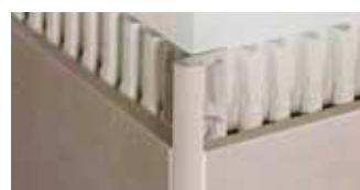
Schlüter-RONDEC ist ein dekoratives Profil aus Edelstahl, farbig beschichtetem/strukturbeschichtetem Aluminium, eloxiertem Aluminium, verchromtem Messing oder farbigem PVC für symmetrisch gerundete Wandaußenecken an Fliesenbelägen sowie Sockel- und Belagsabschlüssen, das die Fliesenkantern vor mechanischer Beschädigung schützt.
