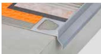
Schlüter-BARA-RKK ist ein T-förmiges Abschlussprofil mit kurzer Tropfkante zur Verlegung auf einen fertigen Gefällestrich. Es ist für einen Konstruktionsaufbau mit der Verbundabdichtung Schlüter-DITRA ausgelegt. Durch die geschlossene Aufkantung erhält man einen sauberen Fliesenabschluss.
