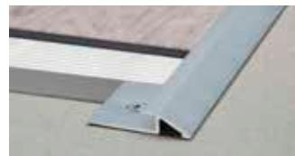
Schlüter-VINPRO-U ist ein Profil zum stufenlosen Übergang von elastischen Bodenbelägen (z. B. LVT-Böden) auf niedrigere, angrenzende Beläge. Durch die abgeschrägte Sichtfläche wird die Entstehung einer Stolperkante zwischen verschiedenen hohen Belägen verhindert sowie zusätzlich die Belagskanten wirksam geschützt.
