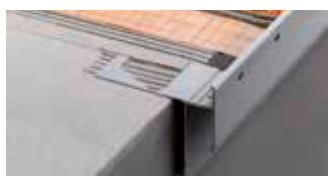
Schlüter-BARA-RAKE ist ein Randprofil mit Tropfkante zur Verlegung auf einen fertigen Gefällestrich. Das Profil BARA-RAKE ist besonders gut für den Konstruktionsaufbau mit der Verbunddrainage Schlüter-DITRA-DRAIN geeignet. Durch die gelochte Aufkantung erhält man einen sauberen Fliesenabschluss.
