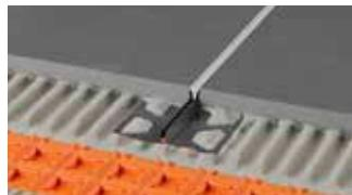
Schlüter-DILEX-F ist eine fast unsichtbare Bewegungsfugenprofil mit einem Bewegungsaufnahmeprofil (DILEX-FCS) aus Hart-PVC sowie einer Einlage aus platinvernetztem Silikonrollenmaterial (DILEX-FIS).
