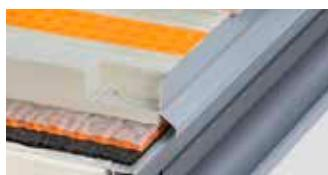
Schlüter-BARA-RK ist ein T-förmiges Abschlussprofil. Der vordere Abschlusschenkel hat einen vorgezogenen Abtropfschenkel, der die Fuge zur TROBA-Flächendrainage überdeckt.
