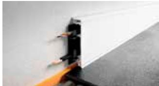
Schlüter-DESIGNBASE-CQ ist ein Profil aus hochwertigem, beschichtetem oder eloxiertem Aluminium zur Erstellung dekorativer Sockelbekleidungen. Die integrierten Kamern des höhenverstellbaren Trägerprofils aus Kunststoff können Kabel verdeckt aufnehmen. Kabelauslässe sind als Zubehör erhältlich. (Produktdatenblatt 16.3)
