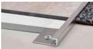
Schlüter-VINPRO-S ist ein spezielles Abschlussprofil aus eloxiertem Aluminium zum Einfassen elastischer Beläge (z. B. LVT-Böden). Das Profil kann als Kantenschutz für elastische Bodenbeläge, Teppichböden bzw. ähnlich dünnen Belägen Abschlusskante oder als Wandabschlüsse genutzt werden.
