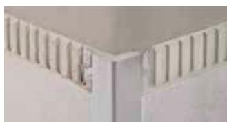
Schlüter-ECK-E ist ein Edelstahl-Eckprofil für Wandaußenecken an Fliesenbelägen und bietet einen stabilen Kantenschutz. Die gelochten Befestigungsschenkel werden bei der Fliesenverlegung in den Fliesenkleber eingebettet. (Produktdatenblatt 2.6)
