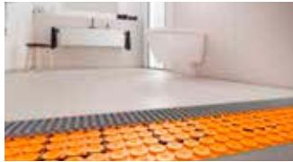
Schlüter-DITRA-HEAT-PS ist eine Polypropylenbahn mit hinterschnittener Noppenstruktur, die rückseitig mit selbstklebendem Trägervlies versehen ist. Nach Abziehen der Schutzfolie kann DITRA-HEAT-PS auf geeigneten Untergründen ohne Verwendung von Fliesenkleber verlegt werden. Die Matte ist wasserundurchlässig und dient zur Aufnahme von Heizkabeln, zur Entkopplung sowie als Dampfdruckausgleichsschicht. (Produktdatenblatt 6.5)
