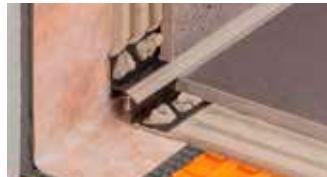
Schlüter-DILEX-EK ist ein zweiteiliges Profil aus Hart- / Weich-Kunststoff mit einer Nut- und Federverbindung für dauerhaft flexible und wartungsfreie Randfugen als Boden- / Wand- bzw. Sockelanschluss.
