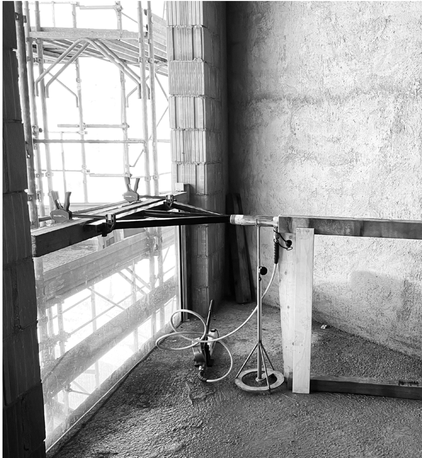
Exemple de test sur chantier avec des essais de poussée jusqu'à 300 kg/m avec des vitrages 10+10 de cm 250 de largeur et 110 cm de hauteur, avec avec un résultat totalement positif
