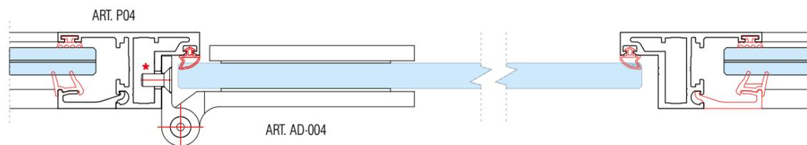
\* - FORO Ø7 SU PROFILO P04 PER INSERTO M5 (ESCLUSO), OPPURE FORO FILETTATO M5 SE IL PROFILO È FORNITO FORATO DIRETTAMENTE DA FARAONE S.r.l.
