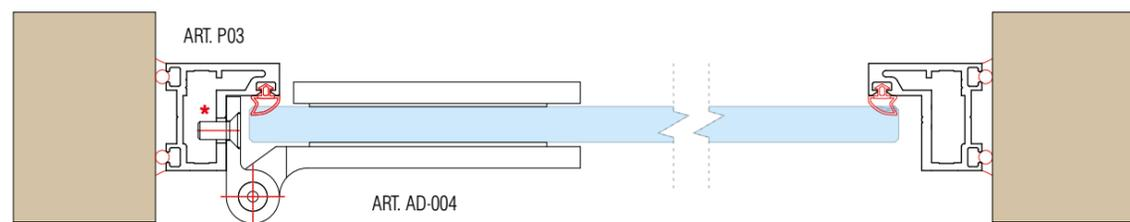
\* - FORO Ø7 SU PROFILO P03 PER INSERTO M5 (ESCLUSO), OPPURE FORO FILETTATO M5 SE IL PROFILO È FORNITO FORATO DIRETTAMENTE DA FARAONE S.r.l.
