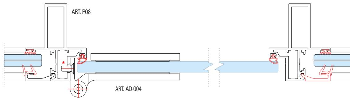
\* - FORO Ø7 SU PROFILO P08 PER INSERTO M5 (ESCLUSO), OPPURE FORO FILETTATO M5 SE IL PROFILO È FORNITO FORATO DIRETTAMENTE DA FARAONE S.r.l.
