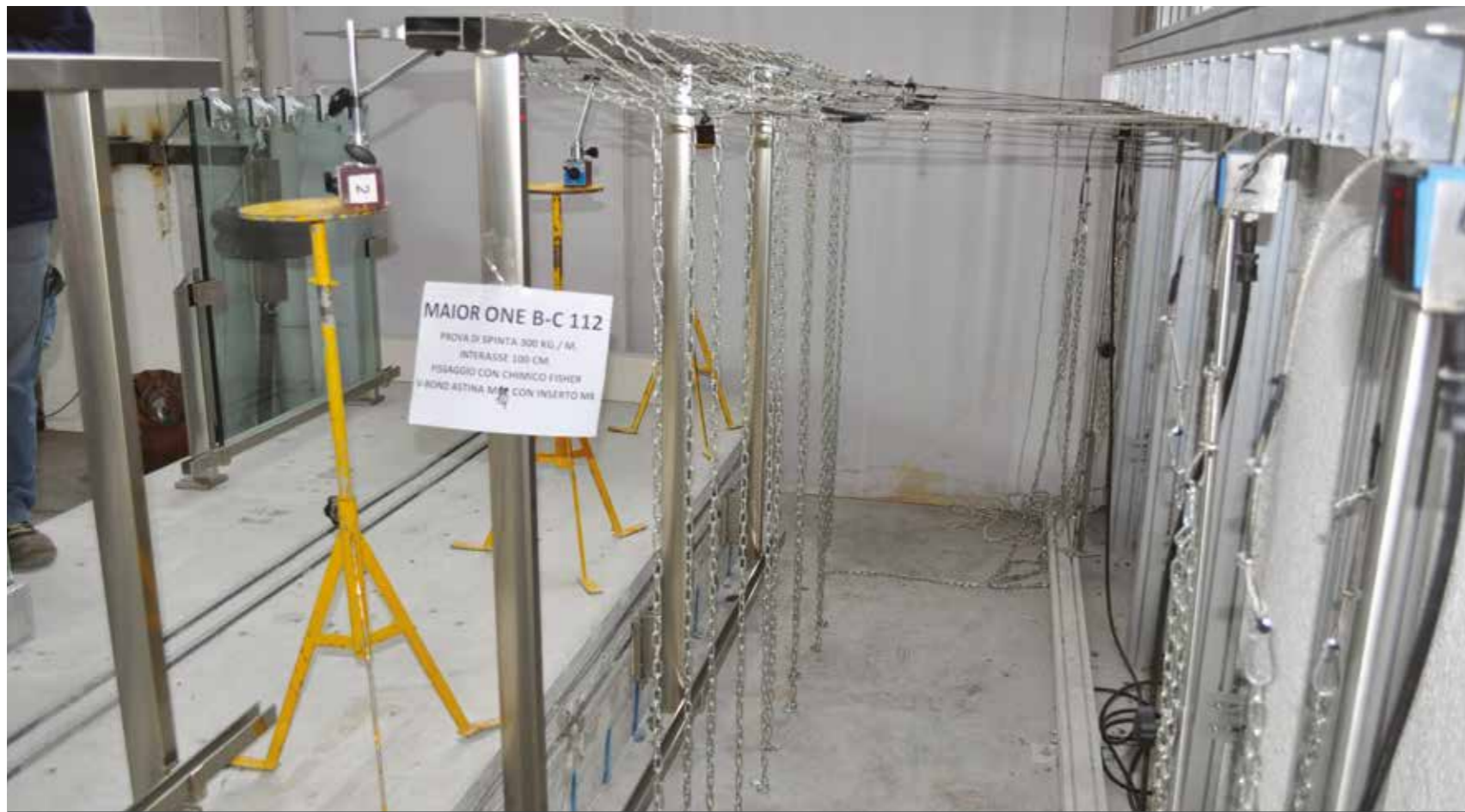
PROVA MAIOR CON MONTAGGIO SU FRONTE SOLAIO. TESTS OF MAIOR WITH FASCIA MOUNTING.
