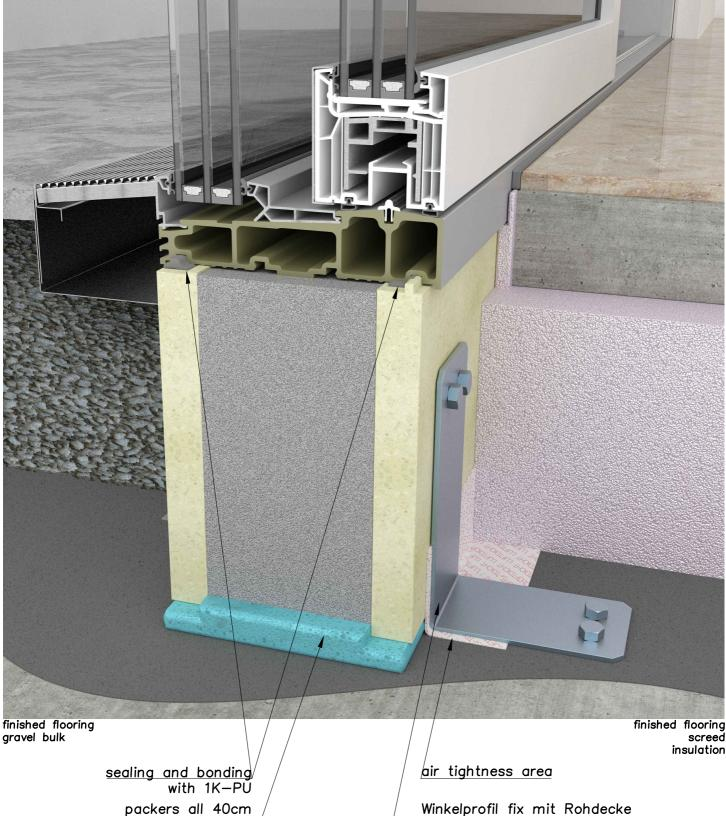
Winkelprofil fix mit Rohdecke und Bodenanschlussprofil verbunden
