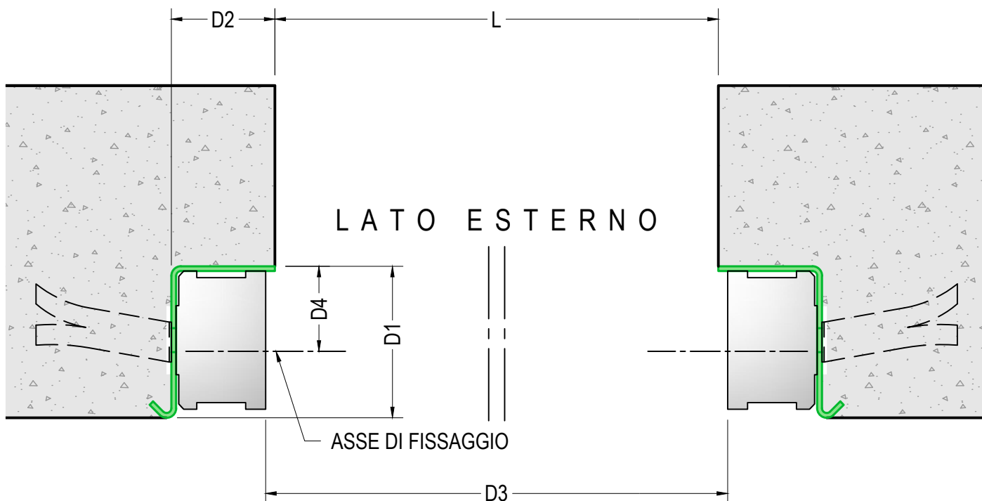
SEZIONE ORIZZONTALE rif. PORTA L=900
