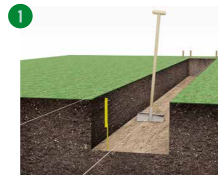
1 Gräv ur en ca 40 cm djup och 60 cm bred ränna till grundläggningen. Du kan behöva gräva djupare för högre murar och vid leriga jordar.
