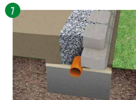
7 Används dräneringsrör ska du lägga detta bakom blocken, med jämnt fall, så att vattnet leds bort från muren.
