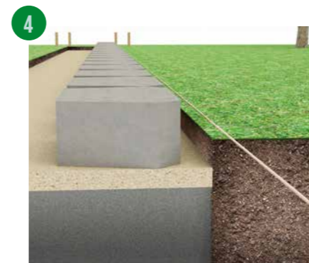
4 Se till att understa skiktet är plant, placera blocken sida vid sida i hela murens längd.
