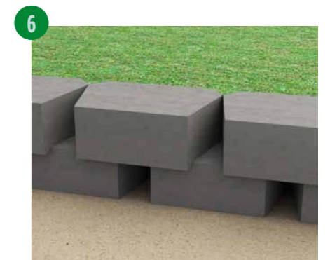
6 Lägg nästa skift med halvstens förskjutning, och se till att klackarna ligger an mot det undre skiftets baksida.
