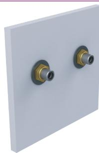
Ajustez le positionnement par rapport à la cloison en jouant sur le contre-écrou et l'écrou, puis serrez l'ensemble afin de le fixer en position.
