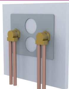
Glissez les raccords à l'arrière de la cloison à travers la plaque de renfort et la cloison. Orientez les tubes en cuivre vers le haut ou le bas, en fonction du côté d'arrivée des canalisations.
