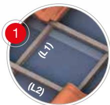
Sur le support de la toiture, il faudra poser une membrane imperméable transpirable, puis installer les liteaux principaux tous les 50/70 cm, parallèlement à la ligne de pente maximale (L1). Les liteaux horizontaux d'appui pour les tuiles (L2) seront fixés selon la longueur utile de chaque modèle de tuile (il faudra vérifier sur le site le respect de la norme UNE - 136020).
