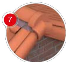
Sur le liteau de faîtage, on posera le sous-faîtage (Mixte, Aluminium ou Rigide), en le fixant avec des agrafes ou des clous. Les rouleaux disposent d'une bande adhésive à base de butyle qu'il faudra fixer sur le profil des tuiles afin d'imperméabiliser la liaison.
