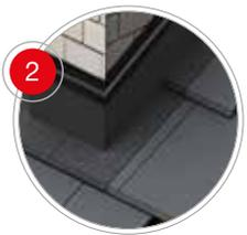
Pour résoudre correctement les rencontres avec des parements et des cheminées, on utilisera les bandes d'étanchéité à usages multiples (Premium ou Aluminium). Dès que ces bandes adhéreront au parement propre et sec, il faudra terminer le travail en posant la ligne d'égoût et en scellant la ligne supérieure au moyen d'un cordon continu de mastic.
