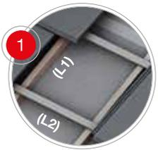
Sur le support de la toiture, il faudra poser une membrane imperméable transpirable, puis installer les liteaux principaux tous les 50/70 cm, parallèlement à la ligne de pente maximale (L1). Les liteaux horizontaux d'appui pour les tuiles (L2) seront fixés selon la longueur utile de chaque modèle de tuile (il faudra vérifier sur le site le respect de la norme DTU en vigueur).
