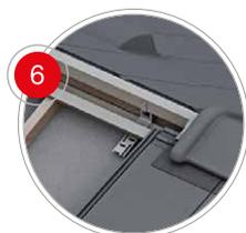
El rastrel que se instala en la cumbrera irá fijado sobre los Soportes de Rastrel. Para su instalación, se deberán fijar al soporte con la pendiente y altura necesarias, de forma que los caballetes queden directamente apoyados sobre las tejas de la última hilada.
