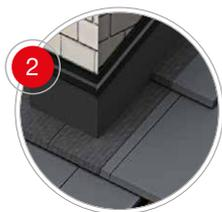
Para resolver adecuadamente encuentros con paramentos y chimeneas se utilizarán las bandas impermeabilizantes Multiusos (Premium o Aluminio). Una vez adheridas al paramento limpio y seco, se deberán rematar superiormente con el Perfil Lagrimero, sellando la línea superior con un cordón continuo de masilla.
