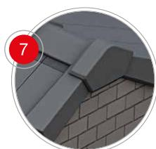
Sobre el rastrel de cumbrera se colocará el Bajo-Cumbrera (Mixto, Aluminio o Rígido), fijándolo con grapas o clavos. Los rollos disponen de bandas de adhesivo butílico para fijarse sobre el perfil de las tejas e impermeabilizar la unión. Finalmente se instalarán los Caballetes y Tapones Laterales, fijándolos con tornillos, clavos o Ganchos de Caballete.
