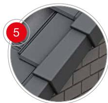
Los remates laterales (izquierdos y derechos) se instalarán solapando sobre las tejas y siguiendo el paso de la teja. Para finalizar el faldón en el lado izquierdo se rematará por encima de la teja o bien media teja, dependiendo de la anchura del faldón y del modo de colocación (en línea o al tresbolillo).
