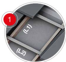
Sobre el soporte de la cubierta se deberá colocar una membrana impermeable transpirable y, a continuación, se instalarán los rastreles principales cada 50/70 cm, paralelos a la línea de máxima pendiente (L1). Sobre los principales se fijarán los rastreles horizontales de apoyo para las tejas (L2), según la longitud útil de cada modelo de teja.
