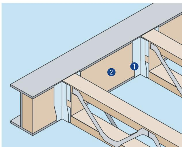
**PD12: Appui sur membrures basses contre un profil métallique**
