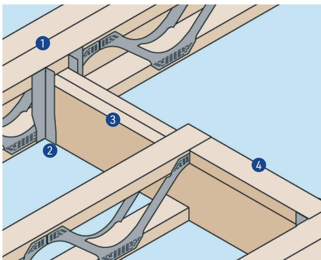
**PD23: Appui sur membrures hautes de poutres : ouverture avec poutres porteuses doublés et chevêtres en bois reconstitué**
