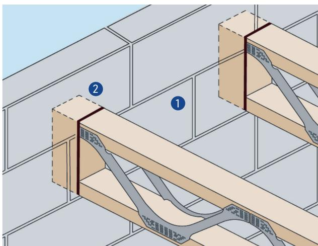
**PSD 01: Appui sur membrures basses : poutres encastrées dans mur maçonné**
