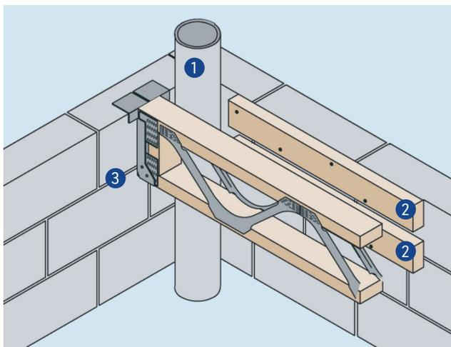
**PD03: Fixation autour d'un conduit de ventilation avec liernes**
