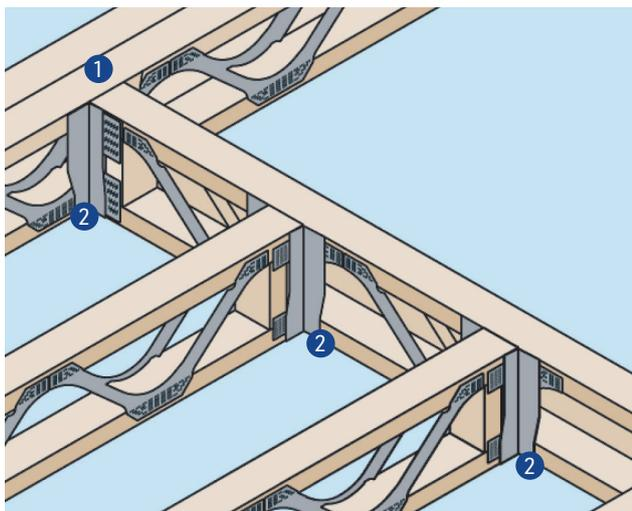
**PD22: Ouverture avec poutre porteuse doublée et poutres POSI® en chevêtre**
