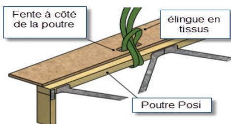
Il faut de préférence utiliser une élingue en tissu et éviter d'utiliser des chaînes ou des câbles métalliques qui peuvent endommager les poutres. Des anneaux de levage ou des trous de levage peuvent aussi être prévu pour le levage.
