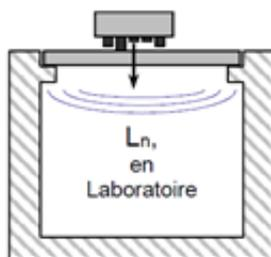
**Figure 32 : Essai en laboratoire de détermination des performances au bruit d'impact**
