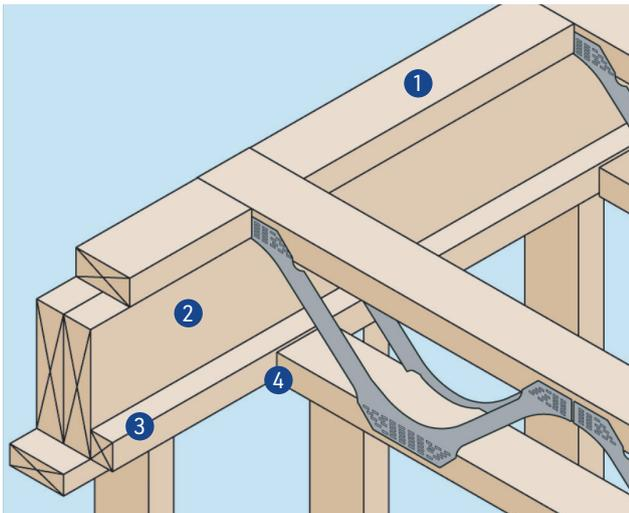
**PD07: Appui sur membrures hautes - liaison plancher ossature avec entretoise**
