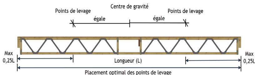
Afin d'éviter toutes détériorations de la structure, il est recommandé de les maintenir horizontalement et de privilégier la manutention au niveau des points de levage.
