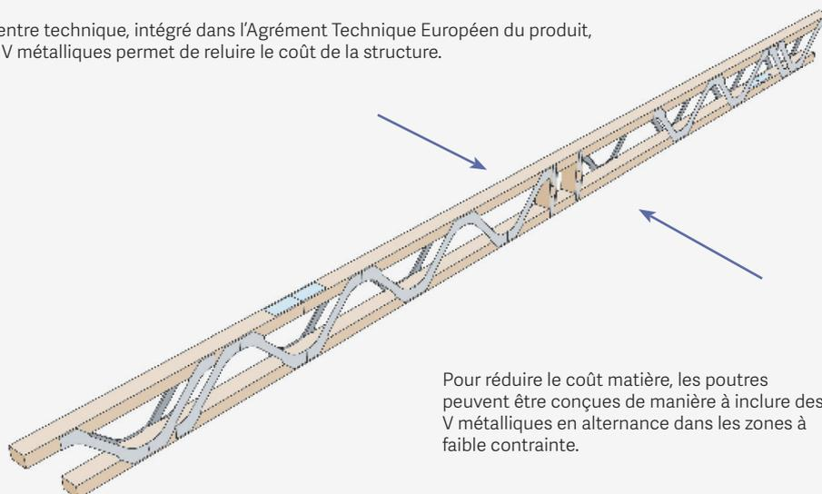
Pour réduire le coût matière, les poutres peuvent être conçues de manière à inclure des V métalliques en alternance dans les zones à faible contrainte.
