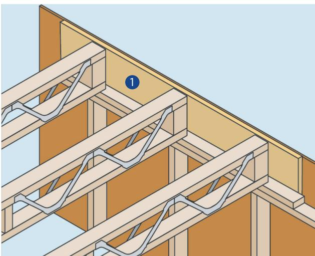
**PD09: Appui sur membrures basses : ossature avec panneaux OSB**
