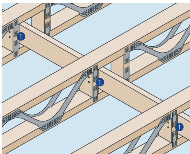
**PD17: Raidisseur inséré à l'intérieur de la poutre**
