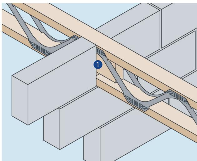
**PD13: Appui bas sur mur de refend : mur intérieur maçonnerie avec poutre en continue et cale**
