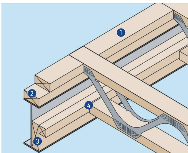
**PD11: Appui sur membrures hautes sur un profil métallique**
