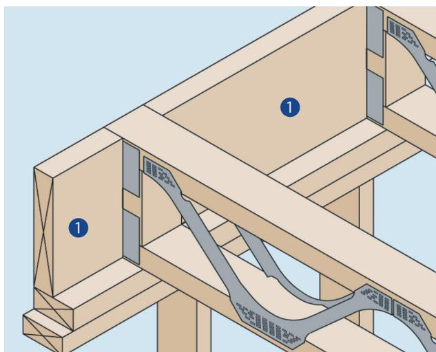
**PD06: Appui sur membrures basses : ossature avec cale d'appui**
