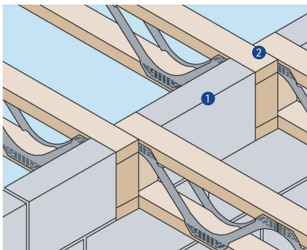
**PD14: Appui bas contre mur de refend : mur intérieur maçonnerie avec chevauchement**
