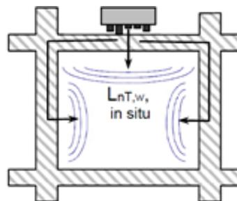
**Figure 33 : Essai in situ de détermination des performances au bruit d'impact**
