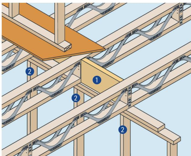
**PD10: Support de cloison intermédiaire sur mur à ossature bois**
