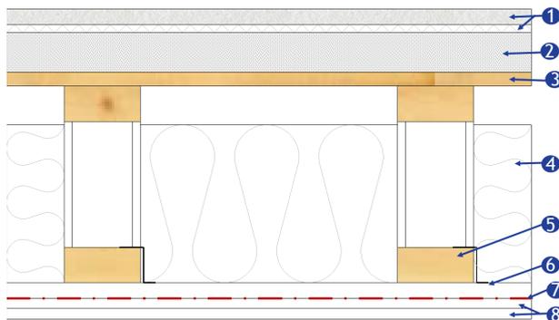
1. Chape sèche en plâtre ou fibre-gypse (20 mm), en une ou deux couches, sur isolant en laine de roche ou fibre de bois (sous avis technique), avec tout type de revêtement de sol, hors carrelage. Exemple : les panneaux de fibres-gypse fermacell®
