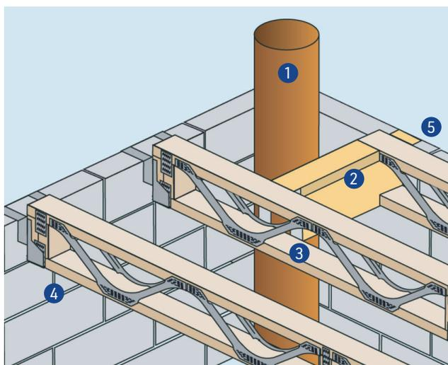
**PD04: Conduit de ventilation avec trémie**
