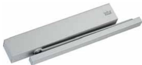
Le ferme-porte TS 99 au design Contur est une solution avec fonction débrayable à partir d'un angle d'ouverture > à 0°. Combiné à un système de détection de fumée, il peut être utilisé comme ferme-porte sur les portes résistantes au feu.
