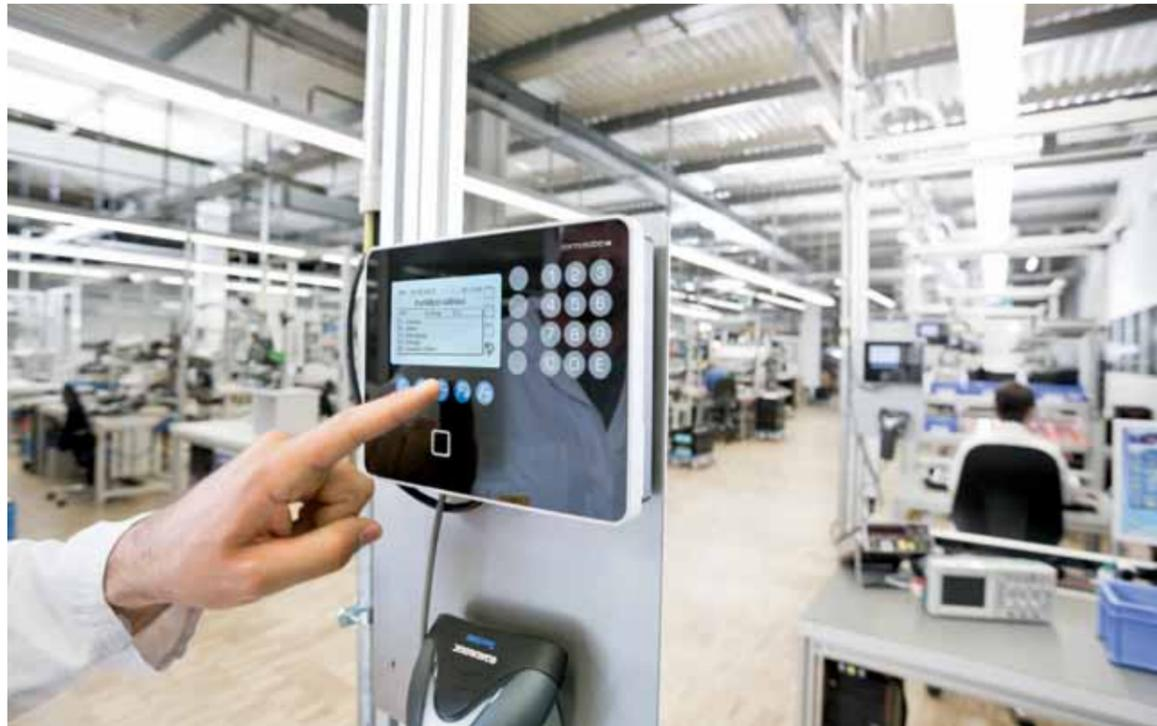
Le terminal B-eco propose une solution conviviale pour toutes les tâches de collecte de données avec identification personnelle par badge RFID et pour la saisie des données de commande par scanner code-barres CCD.
