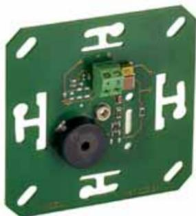
L'antenne peut être installée dans des boîtiers individuels ou mis à disposition par le client. Le composant s'adapte à de nombreux capots d'interrupteurs européens (par ex. Jung, Gira, Merten, Feller). Pour la marque Siedle, il existe des formulaires d'installation sur mesure.
