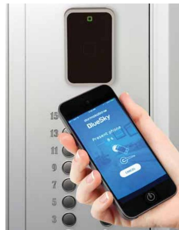
La commande d'accès via lecteur contrôle des points d'accès particuliers comme les ascenseurs, les accès aux parkings et autres portes disposant de gâche ou commandes électriques.
