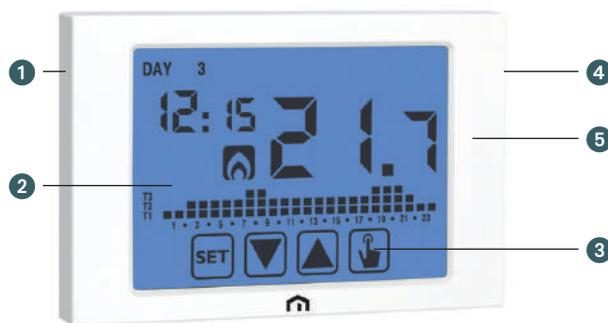
Cronotermostato elettronico touch screen con display retroilluminato, programmazione settimanale e installazione a parete, progettato per la regolazione della temperatura ambiente sia in modalità riscaldamento (inverno) sia in modalità condizionamento (estate). La tastiera è costituita da quattro icone poste sulla parte inferiore del display sensibile al tocco (touch screen). Disponibile nelle versioni con alimentazione da rete elettrica o a batterie
