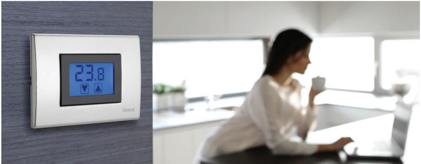
Termostato elettronico touch screen con installazione da incasso su scatola 3 moduli, progettato per il controllo della temperatura ambiente sia in riscaldamento che in condizionamento, disponibile sia con alimentazione da rete elettrica che a batterie.
