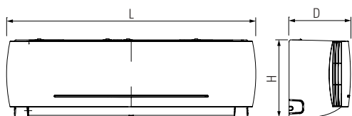
Unità interna / Indoor unit
