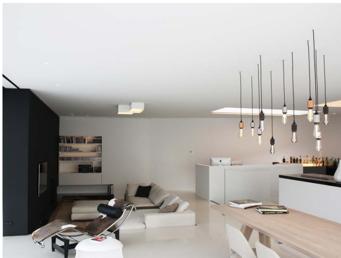
Résidentiel - Salon - BELGIQUE Plafond blanc avec intégration lumineuse et caisson rétroéclairé Installation : MonaVisa
