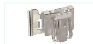
La griffe de terre permet le serrage du cuivre nu le long du chemin de câbles fil pour câblette de terre de diamètre 16 à 35 mm<sup>2</sup>.
