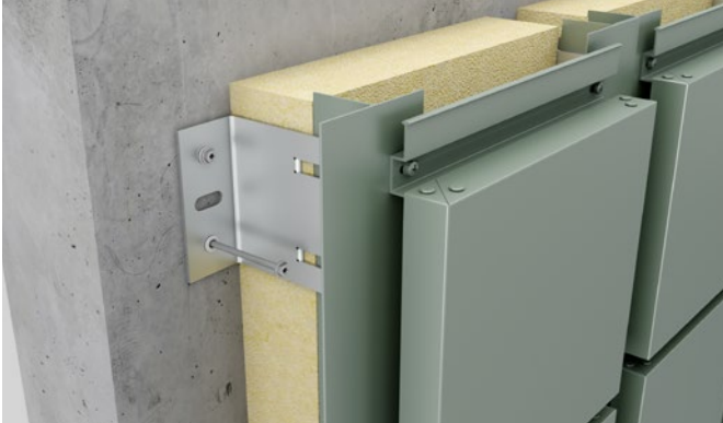
Montaż fasad wentylowanych
