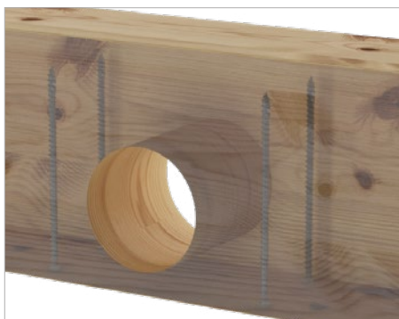
Wzmocnienie belki w miejscu osłabionym otworem
