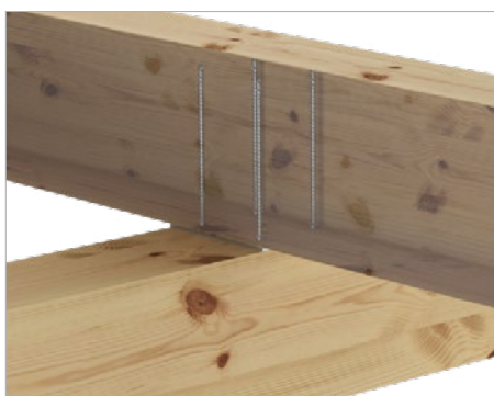
Wzmocnienie w miejscu podparcia
