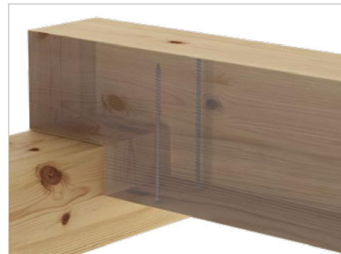
Zabezpieczenie przed pęknięciem belki z wcięciem
