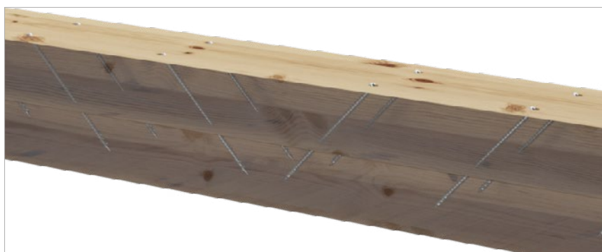
Wzmocnienie poprzez dodanie drugiej belki
