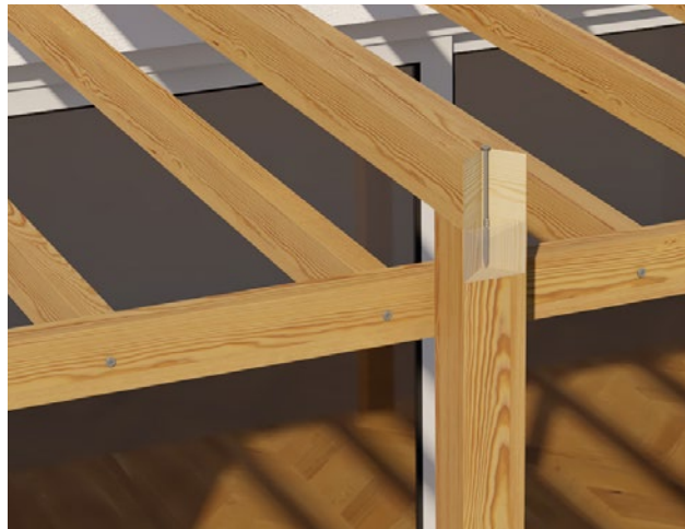
Połączenie belek w konstrukcji drewnianej pergoli
