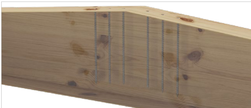
Wzmocnienie wkrętami w strefie kalenicowej
