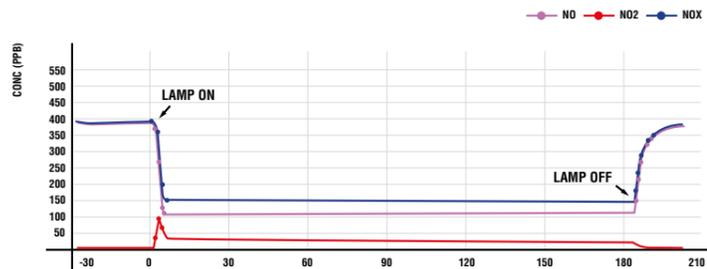
Nell'immagine una miscela inquinante viene fatta transitare nella camera di reazione del simulatore. Con la luce, l'azione fotocatalitica di SOLARYA 65 agisce riducendo il tenore di inquinante. L'effetto permane fino a spegnimento.
