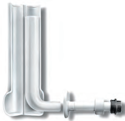
80006560 n.1 tubo di risciacquamento 35x11cm con rivestimento e tappo, regolabile in altezza (+2-2cm), cannotto 22 cm, rosone eccentrico e morsetto combinato Ø 48-58 mm con coprimorsetto bianco no.1 35x11cm adjustable flush pipe (+2-2 cm) with lining and cap, 22 cm joint eccentric escutcheon and Ø 48-58 mm combined clamp with cover-white
