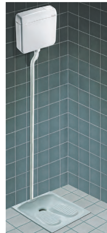
80003500 n.1 Alta posizione per turca tubo esterno di 200 cm Ø 32-32 mm con raccordo Ø 50 - 32 mm, guarnizione 6 mm 2 fascette inossidabili con viti no.1 200 cm Ø 32-32 mm high-set exposed pipe for Turkish bowl, with Ø 50-32 mm joint 6 mm gasket, 2 stainless steel fasteners with screws
