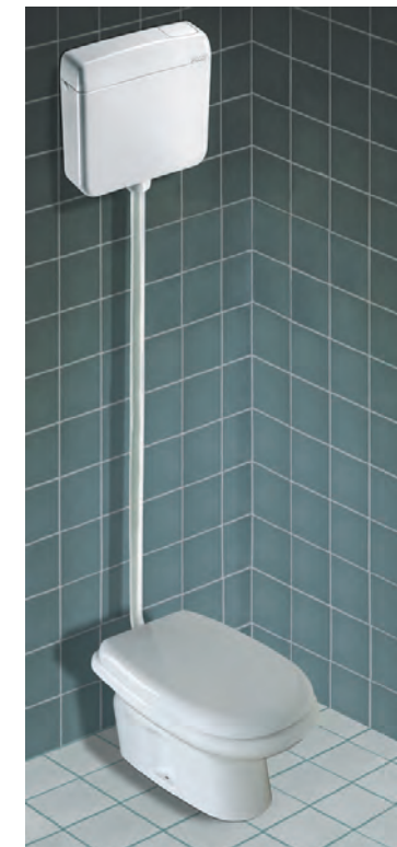
80003500 n.1 Alta posizione per turca tubo esterno di 200 cm Ø 32-32 mm con raccordo Ø 50 - 32 mm, guarnizione 6 mm 2 fascette inossidabili con viti no.1 200 cm Ø 32-32 mm high-set exposed pipe for Turkish bowl, with Ø 50-32 mm joint 6 mm gasket, 2 stainless steel fasteners with screws
