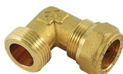
1104FD Raccordo curvo, dado e ogiva per tubo rame, filettatura maschio con sede piana per tubo acciaio corrugato e guarnizione piana
