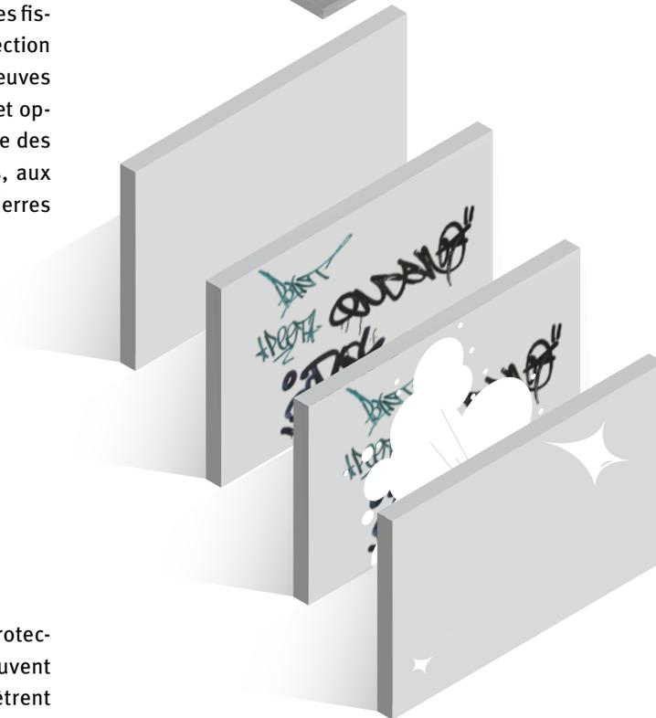
**IMPRÉGNATIONS INCOLORES :** Les systèmes de protection RECKLI OS-D, OS-HO et OS-Premium peuvent être appliqués sur le béton jeune. Ils pénètrent dans la surface et se fixent chimiquement avec elle. Comme les imprégnations ne forment pas de film, la teinte de la surface en béton reste inchangée.
