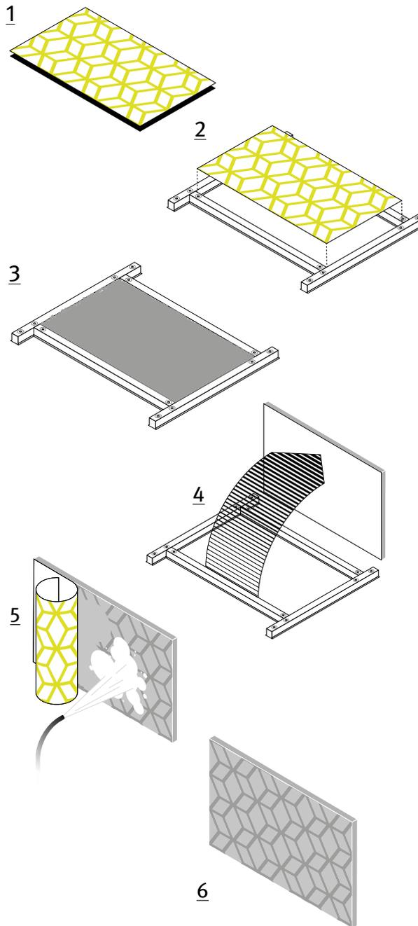
Le procédé est simple: RECKLI artico® neo est un film plastique sur lequel graphiques et photos sont imprimés avec un activateur de béton de grande qualité. L'activateur de béton provoque une prise du béton décalée dans le temps de sorte que celui-ci peut être lessivé en surface après le décoffrage. La laitance supérieure du béton est partiellement éliminée. Grâce au contraste entre les surfaces lessivées et les surfaces lisses, graphiques ou photos deviennent visibles.
