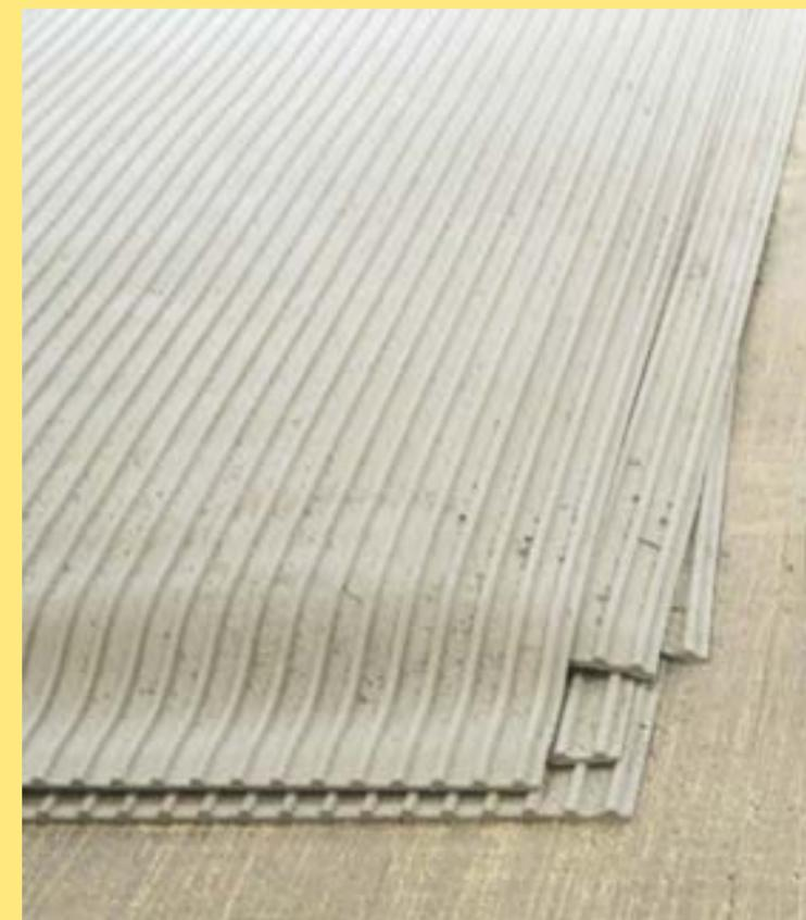
Nos matrices sont fabriquées à la main à l'usine. Le moulage d'une structure naturelle, un dessin ou un design numérique servent de modèle. Partant de là, les experts fabriquent dans notre menuiserie un modèle positif sur lequel sont coulées les matrices. Le mélange d'élastomères pour les matrices, que nous continuons de développer sans cesse, garantit la reproduction exacte des détails dans le béton et les rend si résistantes qu'elles peuvent s'utiliser jusqu'à 100 fois.
