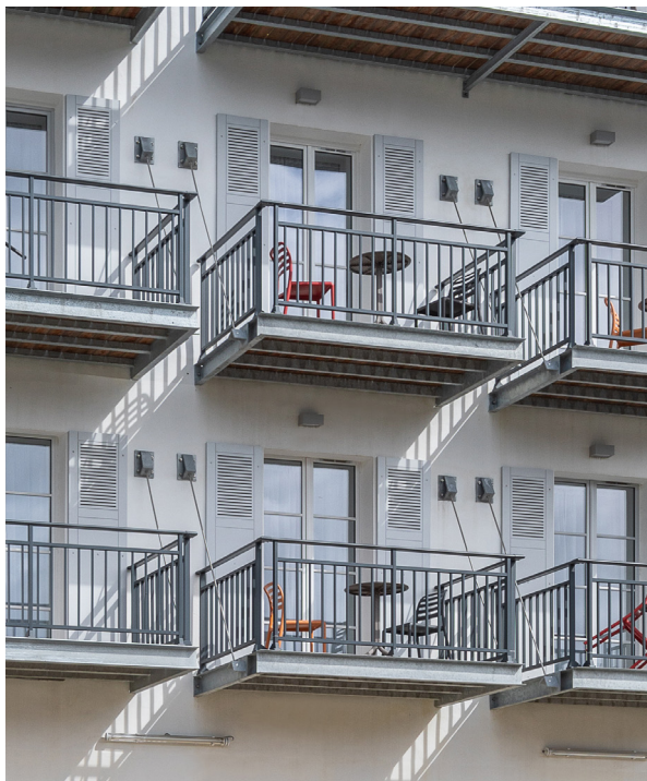
^ BAROK 1 vide sous main courante Pose sur dalle Barreaudage 15 x 30 mm RAL Gris 7016
