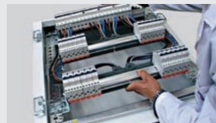
Grazie al telaio estraibile le operazioni di collegamento degli interruttori diventano più facili, permettendo prima il pratico cablaggio a banco e successivamente l'installazione all'interno della cassa a circuito ultimato.
