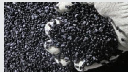
Preso e spina sono realizzate parzialmente in Renycle®, una gamma di tecnopolimeri speciali, ottenuti da recupero di nylon, con impatto ambientale molto inferiore rispetto a materiale vergine, calcolato per ciascuna formulazione, tramite LCA. Di conseguenza è ideale per i progetti in cui la sostenibilità è un requisito fondamentale.
