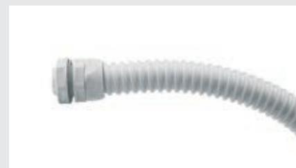
Una volta in sede, la guaina può ruotare liberamente, pur mantenendo il grado di protezione IP54, grazie ai raccordi girevoli dritti. In questo modo, le movimentazioni delle guaine già collegate a scatole e quadri risultano più agevoli.
