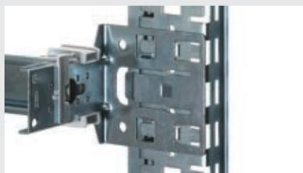
Le staffe delle guide sono state progettate per essere montate senza viti grazie all'innesto sui profili funzionali. Inoltre l'innovativo supporto consente il fissaggio delle guide alle staffe e la loro regolazione in profondità senza l'utilizzo di viti ed attrezzi.
