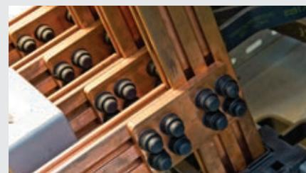
Grazie alla preforatura sulle barre piatte a passo 25mm è possibile effettuare una rapida connessione in barra, bandella oppure in cavo. Inoltre, è possibile effettuare in modo semplice e rapido giunzioni tra barre piatte e barre sagomate utilizzando i giunti dedicati.
