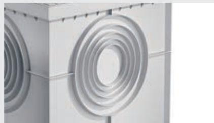
I lati del pozzetto presentano pretranciature di differenti diametri per l'ingresso di cavidotti. Il fondo sfondabile permette che i pozzetti PZ possano essere sovrapposti, realizzando un sistema modulare per aumentare la profondità e la capienza del pozzetto.
