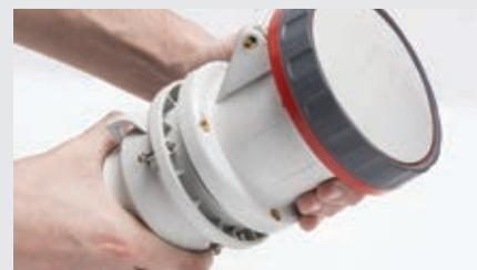
Le versioni 16-32A si contraddistinguono per la chiusura corpo-impugnatura brevettata con rotazione 1/4 di giro SAFE- LOCK, mentre le versioni 63-125A dispongono di un sistema di chiusura con viti imperdibili avvitate su inserti in ottone realizzati con flangia di contrasto maggiorata.
