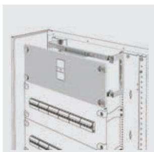
**KIT DI INSTALLAZIONE PER INTERRUTTORI SCATOLATI FINO A 630 A IN ESECUZIONE FISSA CON COMANDO MOTORE**
