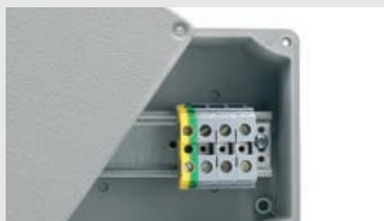
Le cassette, con grado di protezione IP66, possono essere usate come derivazione, con la possibilità di montare piastre di fondo o guide DIN. Il coperchio è dotato di viti di fissaggio imperdibili ed in acciaio inox, mentre il fondo è dotato di inserto per la messa a terra.
