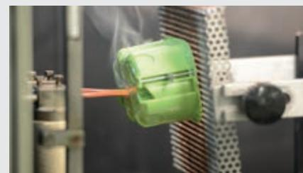
La costante ricerca nel campo dei materiali plastici ha permesso di utilizzare materiali dall'elevata resistenza meccanica, Halogen Free, in grado di superare la prova del filo incandescente GWT 850°C, in accordo alla specifica norma di prodotto e alla norma impianti CEI 64/8.
