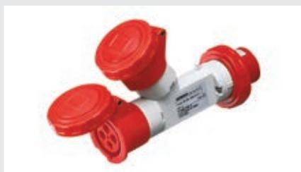
Disponibili nella gamma IEC 309 MA differenti modelli di moltiplicatori mobili stagni dotati di 2 o 3 uscite con e senza cavo. Sono disponibili con cablaggio a vite e con correnti fino a 32A.
