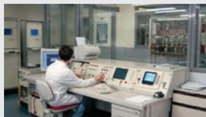
I quadri di stringa vengono testati nei laboratori GEWISS, superando positivamente tutte le prove previste dalle norme EN 61439-1 ed EN 61439-2 per il rilascio della certificazione di prodotto.
