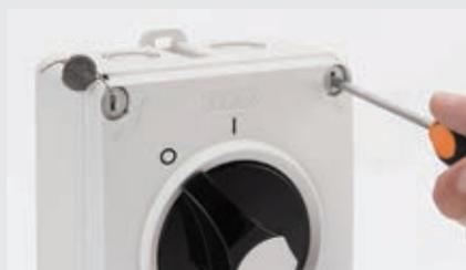
La parte frontale delle versioni con cassetta in materiale isolante è fissato con sole 4 viti imperdibili e piombabili ad 1/4 di giro: un sistema semplice ed innovativo, che consente di fissare o rimuovere il frontale in tempi notevolmente ridotti rispetto a qualsiasi altro sistema oggi disponibile sul mercato.
