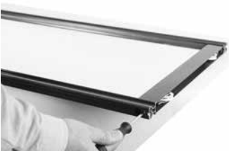
Pyörästä on säädettävä ulkoasentoon ennen oven pystyyn nostoa. Ilman säätöä alakiskon pinta voi vaurioitua.
