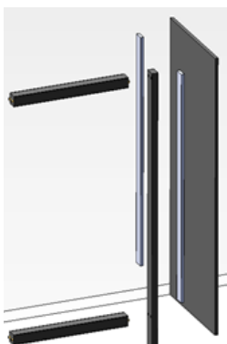
URPKPÄÄTY(3-12)O, päätypaketti oikea Päätylevy, 870x534x16 Tukilista 2kpl, 704x50x16 Raamin pystypäätylevy, 870x32x52 Raamin vaakalista 2kpl, 299-999x32x52
