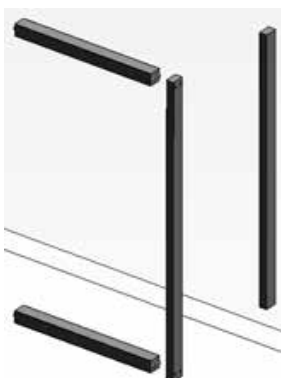
URPKVÄLI(3-12), välisapaketti Raamin pystyvälilista, 768x32x52 Raamin vaakalista 2kpl, 299-999x32x52 Raamin takalista, 704x32x52
