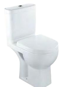
**NF** **E0374-00 Odéon Up - Pack WC compact sortie horizontale** 60 x 36,5 cm. Hauteur confort 43 cm. Réservoir réversible complet monté en usine, avec mécanisme double chasse 3/6 L à bouton poussoir chromé. Robinet flotteur silencieux. Alimentation latérale. Système de montage rapide. Kit de fixation. Abattant thermodur, charnières métal inox, à fixation rapide.
