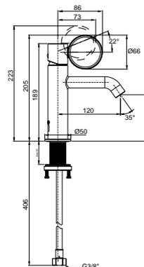
**Mitigeur lavabo - modèle standard avec flexibles d'alimentation.** Poignée Bijou. Aérateur caché anti-calcaire. Bec coudé. Débit limité à 5 l/mn. Sans vidage.
