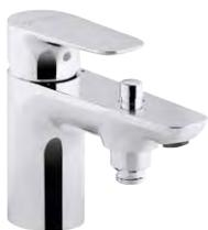
**NF E72284-CP Mitigeur bain-douche monotrou** avec flexibles d'alimentation. Bague-limiteur de température. Eco d'eau : butée sensitive. Inverseur automatique à bouton-poussoir. Flexibles d'alimentation (longueur 500 mm) avec raccords G1/2. Aérateur anti-calcaire "pièce". Clapet anti-retour sur la sortie douche. ECAU : E3/1 C2 A1 U3
