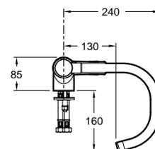
**E72360-CP Aleo - Mitigeur évier, bec tube, avec lexibles d'alimentation PEX.** Bec tube orientable. Bague-limiteur de température. Aérateur anti-calcaire intégré. Percement Ø 35 mm. Débit limité à 8 l/mn
