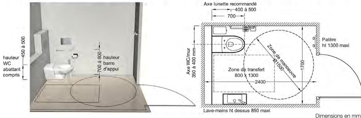
Pour les permis de construire déposés après le 1<sup>er</sup> juillet 2017, la distance entre l'axe de la cuvette de WC et la barre d'appui latérale est comprise entre 400 et 450 mm.
