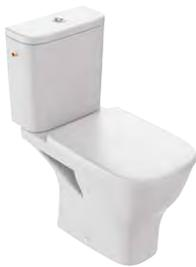
**E76008-00 Struktura - Pack WC SANS BRIDE sortie horizontale** 64,5 x 35,4 cm. Réservoir complet monté en usine avec mécanisme 3/6 L, robinet flotteur silencieux, alimentation latérale. Abattant thermodur, à descente progressive et déclinable charnières métal.
