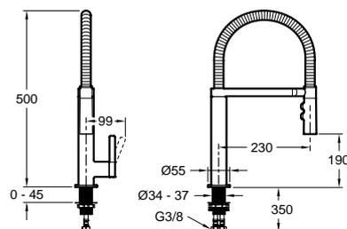
**NF** **E76250-CP Natéo - Mitigeur évier, bec tube orientable et rabattable** pour installation devant une fenêtre, avec flexibles d'alimentation PEX. Bague-limiteur de température. Economiseur d'eau : butée sensitive. Aérateur anticalcaire. Débit : 9l/mn. Percement Ø 35 mm
