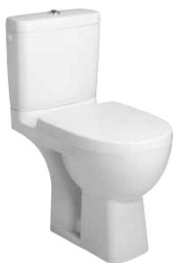
**NF** **E22770-00 Odéon UP Pack WC SANS BRIDE sortie horizontale** 67 x 36,5 cm. Hauteur confort 41 cm. Réservoir complet monté en usine 3/6L. Robinet flotteur silencieux, alimentation latérale, système de montage rapide. Abattant thermodur à descente progressive et déclinable, charnières métal inox. Kit de fixation au sol fourni.
