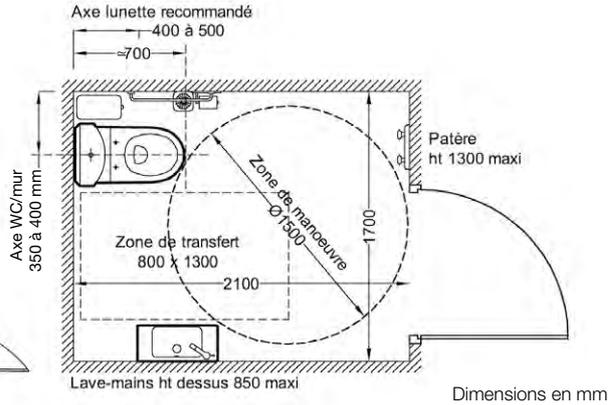
Pour les permis de construire déposés après le 1<sup>er</sup> juillet 2017, la distance entre l'axe de la cuvette de WC et la barre d'appui latérale est comprise entre 400 et 450 mm.
