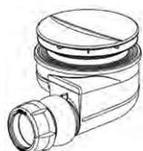
**NF E78161-CP Bonde** haut débit spécialement étudiée pour receveurs extra-plats. Non compatible avec receveurs céramique. Débit 54 L/min. Garde d'eau 50 mm.
