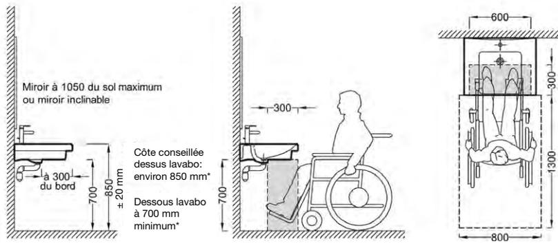
Un lavabo accessible présente un vide en partie inférieure d'au moins 0,30 m de profondeur, 0,60 m de largeur et 0,70 m de hauteur permettant le passage des pieds et des genoux d'une personne en fauteuil roulant. Le choix de l'équipement ainsi que le choix et le positionnement de la robinetterie permettent un usage complet du lavabo en position assis en veillant notamment à la facilité de leur préhension.
