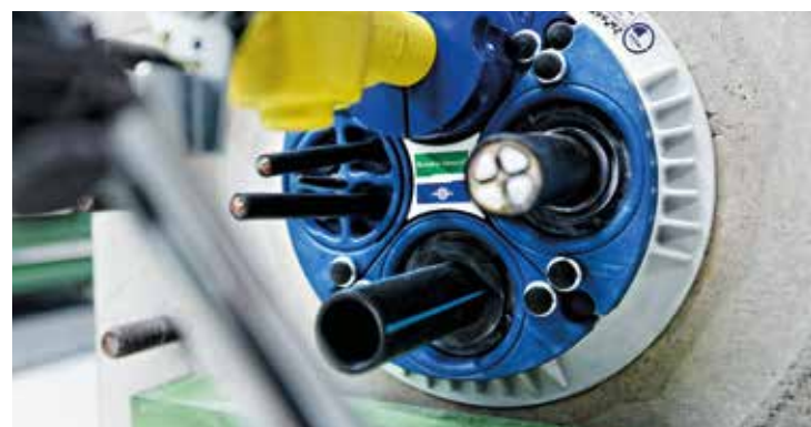
Belastungsgrenzen-Test an Mehrsparten-Hauseinführung
