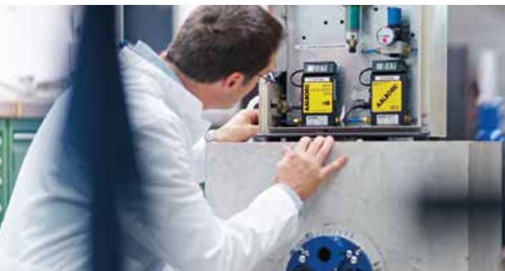
Dichtigkeitsprüfung an einer Mehrsparten-Hauseinführung
