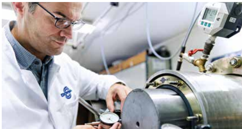
Rutschgrenzen-Test bei einem Dichtungseinsatz
