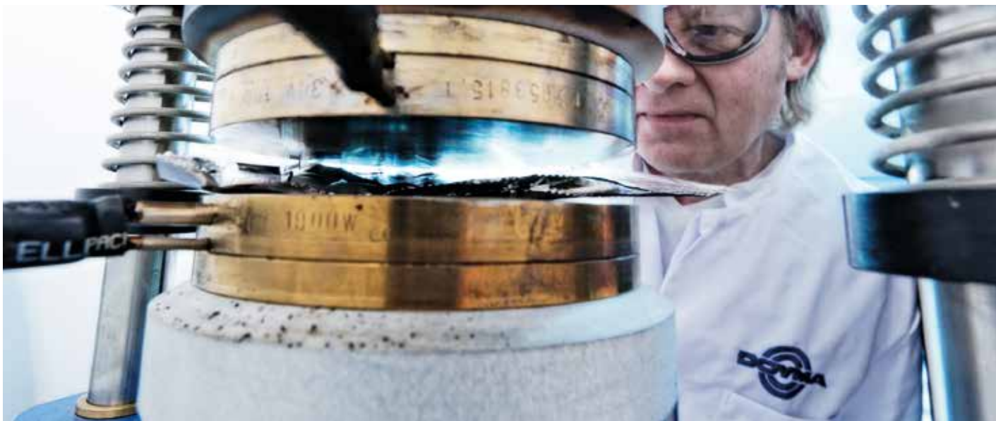
Blähdruckmessung an intumeszierendem Material
