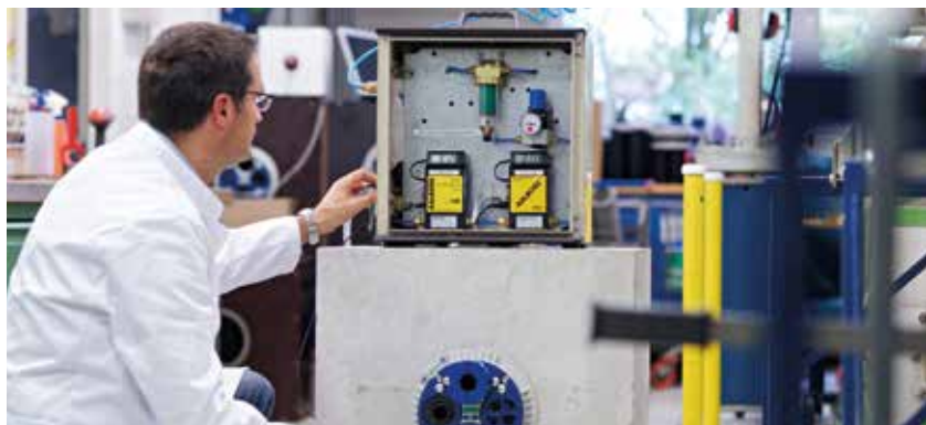
Dichtigkeitsprüfung von Gewerken einer Mehrsparten-Hauseinführung
