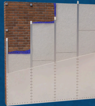
PARED INTERNA CZ DETRÁS DE PLACA DE YESO
