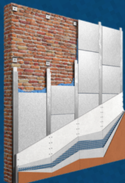
MUR EXTÉRIEUR DERRIÈRE PLAQUE EN FIBROCIMENT OU EN GYPSE.
