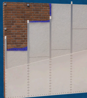
MUR INTÉRIEURE CZ DERRIÈRE PLAQUE EN PLÂTRE
