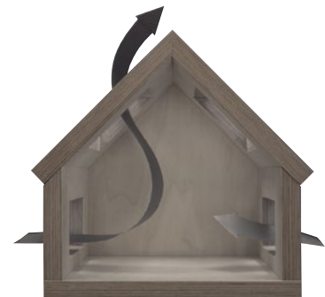
Durch Nutzung des Kamineffekts kann die Abkühlung über die Nacht beschleunigt und optimiert werden.
