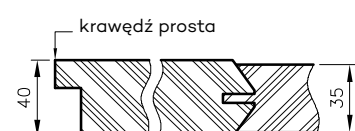
Przekrój poziomy drzwi Elsa
