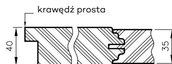
Przekrój poziomy drzwi Nestor
