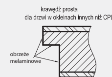
okładzina z płaszczyzny szerokiej (HDF oklejony laminatem CPL) zawięta metodą DRE - formingu
