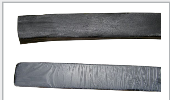
Vergleich Quellband mit und ohne Schutzhülle
