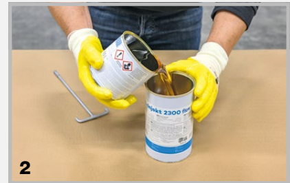
2 Den kompletten Inhalt der Härterkomponente A in die Kombidose der Komponente B füllen.
