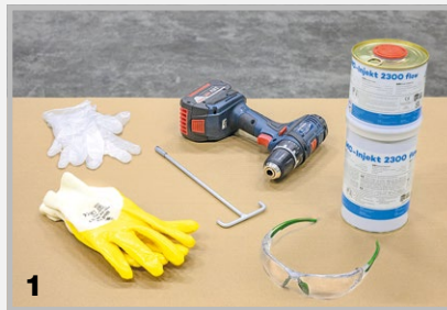
1 Verarbeitungsmaterial: Schutzhandschuhe, Schutzbrille, Akkuschrauber, geeignetes Rührwerk
