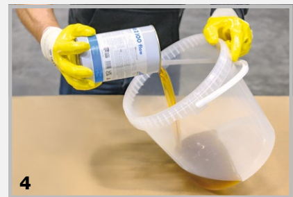
4 Das durchmischte Material in ein sauberes, staubfreies Gefäß für die maschinelle oder manuelle Weiterverarbeitung umfüllen.
